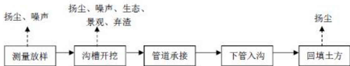
图 9：管道施工施工工艺流程及产污位置图
