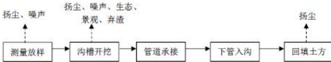
图 10：管道施工施工工艺流程及产污位置图
