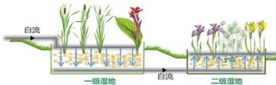
图 4-7：人工湿地处理流程示意图
