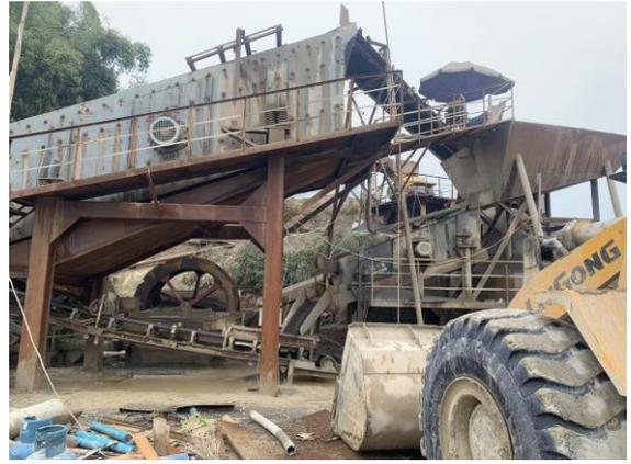
照片 2：项目已建的生产设备（振动筛）
