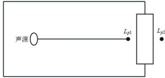
图 4-2 室内声源等效为室外声源图例
